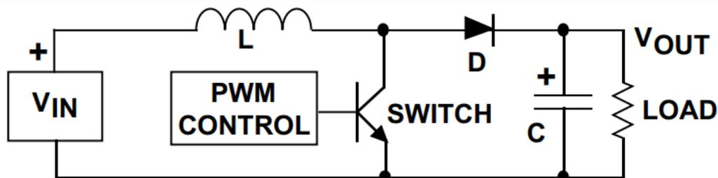
Consideraremos que el transistor se comporta como un interruptor ideal que abre (corte) y cierra (saturación) dependiendo de si la señal de voltaje en su base es positiva (ON) o cero (OFF) y que el diodo conduce solamente cuando el transistor está apagado (OFF), como se muestra en la siguiente figura:
