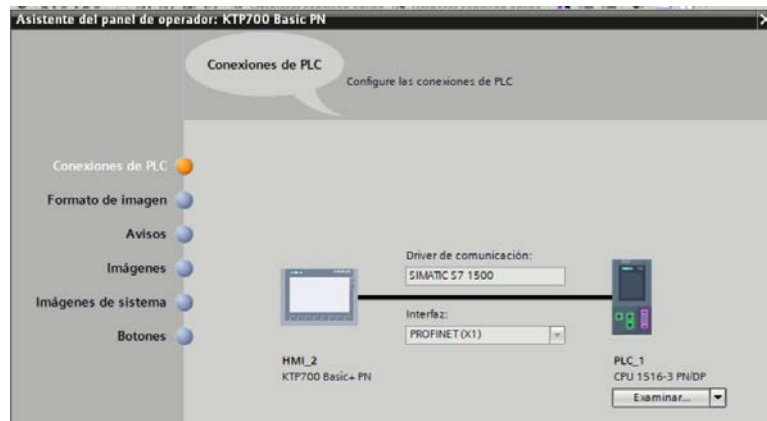
Ilustración 33 Conexión con el PLC
