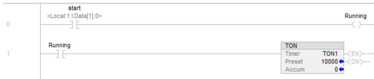
6. Añadir un peldaño y contacto en la programación, luego asignar el **bit DN** de la variable tipo timer al contacto.
