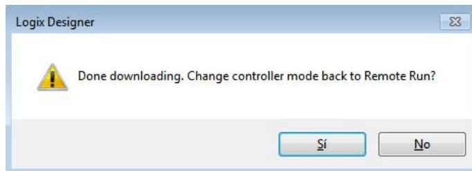
4. Finalmente se puede observar en el estado del controlador que la descarga ha sido realizada con éxito, y el estado del controlador se encuentra en **Run**.
