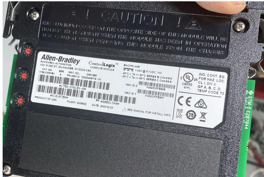
Figura 2: Etiqueta técnica del Módulo Compute del laboratorio.
