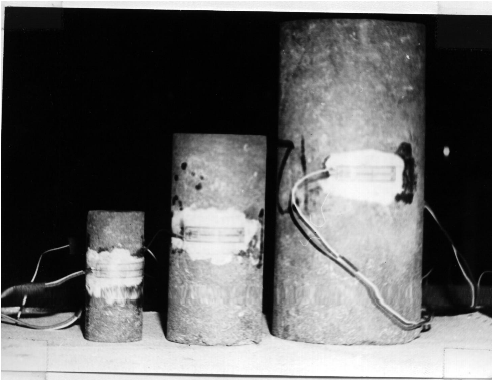
MUESTRAS PARA ENSAYO DE COMPRESION UNIAXIAL, CON EFECTO DE ESCALA
