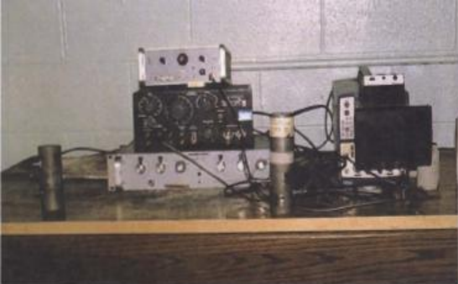
Figura 3.65 Aparato para el ensayo de velocidad sónica (foto L. G. de Vallejo).
