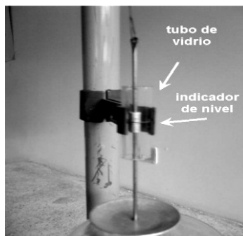
Fig. 2 Tubo con indicador para la nivelación
