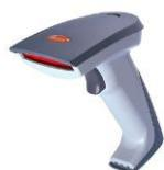
Es un dispositivo electrónico que por medio de un láser lee un código de barras y emite un número en pantalla. Está compuesto por un escáner laser, un decodificado y un cable o antena wifi que actúa
