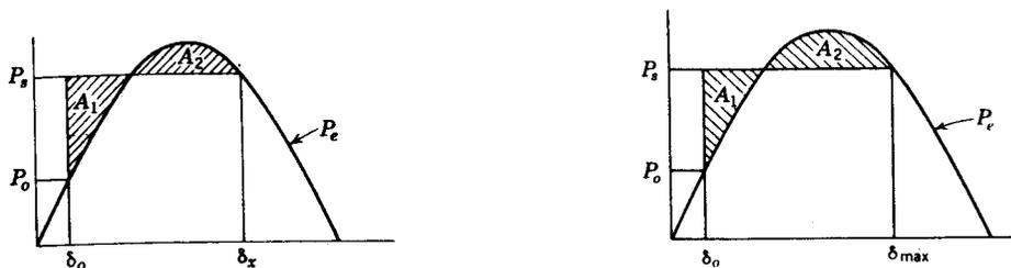
Fig. 14.7 Potencia eléctrica de entrada a un motor, en función del ángulo de par, para el aumento brusco máximo de carga sin pérdida de estabilidad. Las áreas  $A_1$  y  $A_2$  son iguales.
