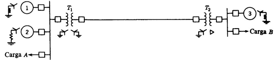
No. 1, Generador-20 000 kVA; 6,6 kV;  $X'' = 0,655$  ohmios
