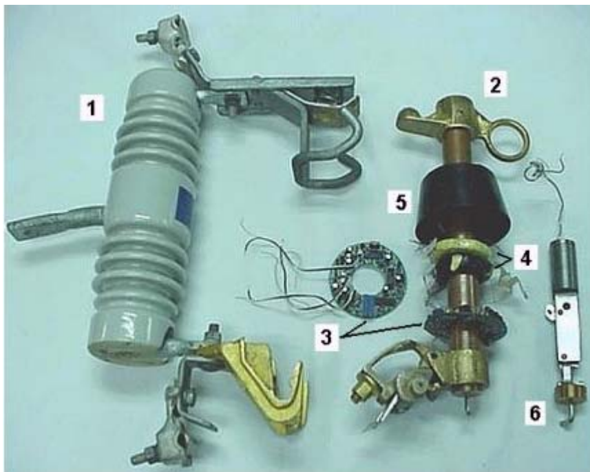
Figura 5 Partes que integran un seccionizador
