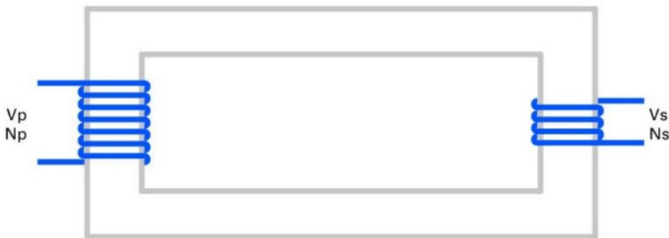
Los transformadores se basan en la inducción electromagnética. Al aplicar una fuerza electromotriz en el devanado primario, es decir una tensión, se origina un flujo magnético en el núcleo de hierro. Este flujo viajará desde el devanado primario hasta el secundario. Con su movimiento originará una fuerza electromagnética en el devanado secundario.
