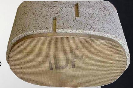
CONVERTIDOR CATALÍTICO DE MONOLÍTICO CERÁMICO
