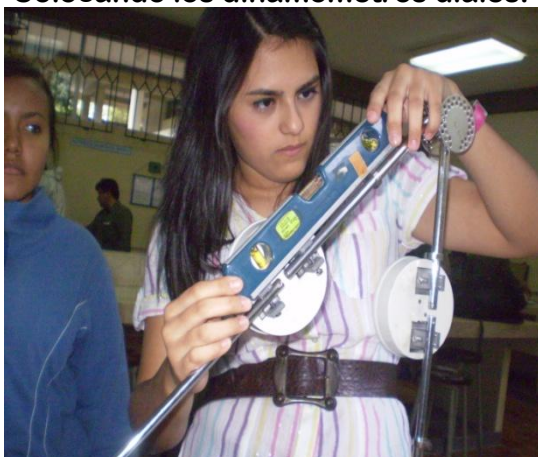
Verificando con el nivel que las barras estén en su posición correcta.
