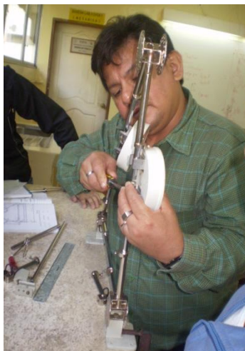
Colocando los dinamómetros diales.
