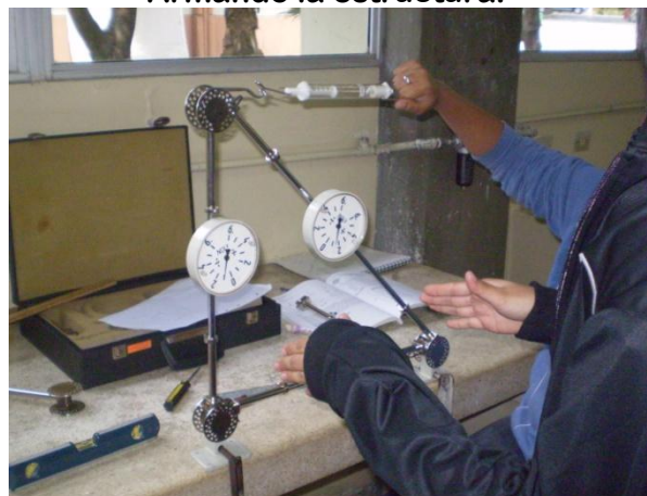
Aplicando fuerza con el dinamómetro a la armadura.
