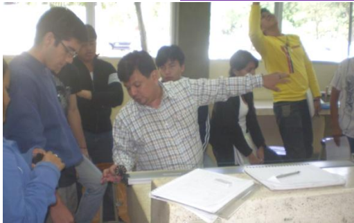
Arreglo del Equipo, verificando que la pista esté paralela al mesón y que la cuerda esté bien colocada en la polea
