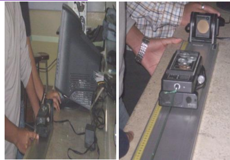
Correcta forma de sostener el carro y soltarlo cuando tiene 5 anillos y 1 en el portamasas
