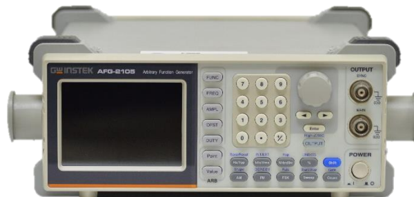
Figura 13: Generador de funciones GWINSTEK.
