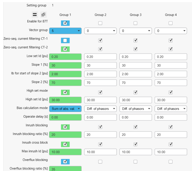
Ilustración 5. Configuración de protección diferencial de relé P5T30
