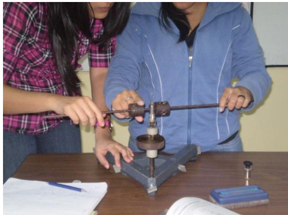
Ajuste de las masas (cilindros) a la varilla.
