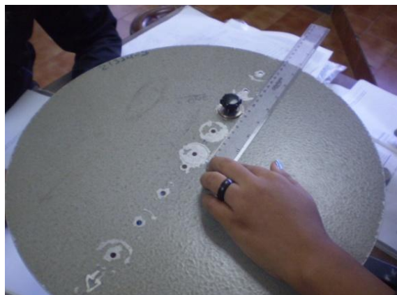
Cambio de posición del disco con respecto al eje y medición del nuevo d .
