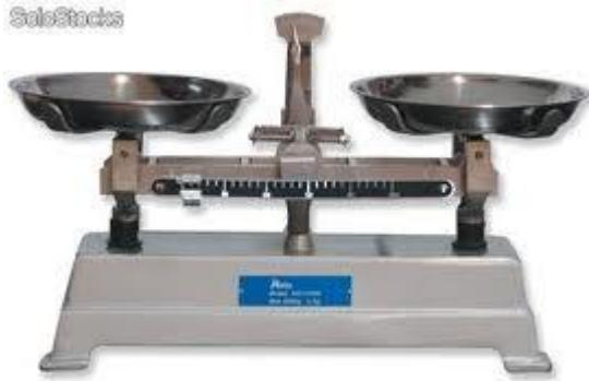
Cuando la medida es directa, la lectura provendrá de la observación de la escala del instrumento por ejemplo, si tenemos una balanza de dos brazos, primero debemos ver si la balanza está calibrada, esto es, que para una posición del cursor en cero gramos ambos platos deben estar nivelados, luego se coloca el objeto en el plato izquierdo y se corre el cursor hasta lograr nivelar nuevamente los dos platos.
