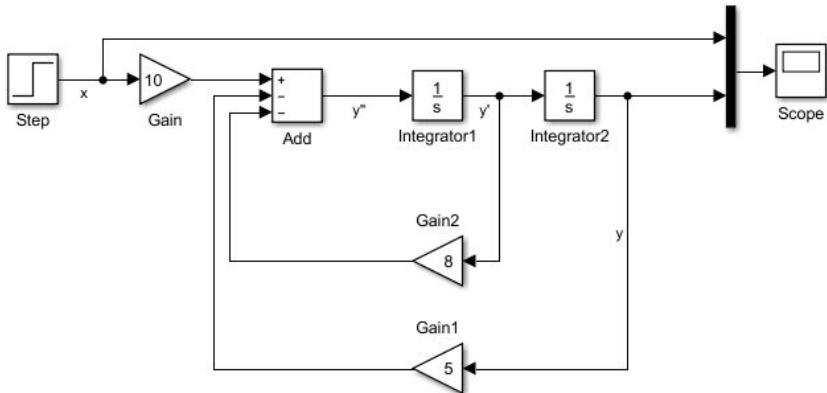
Solo queda conectar los coeficientes con su respectiva señal y colocar bloques de fuentes y de sumideros.
