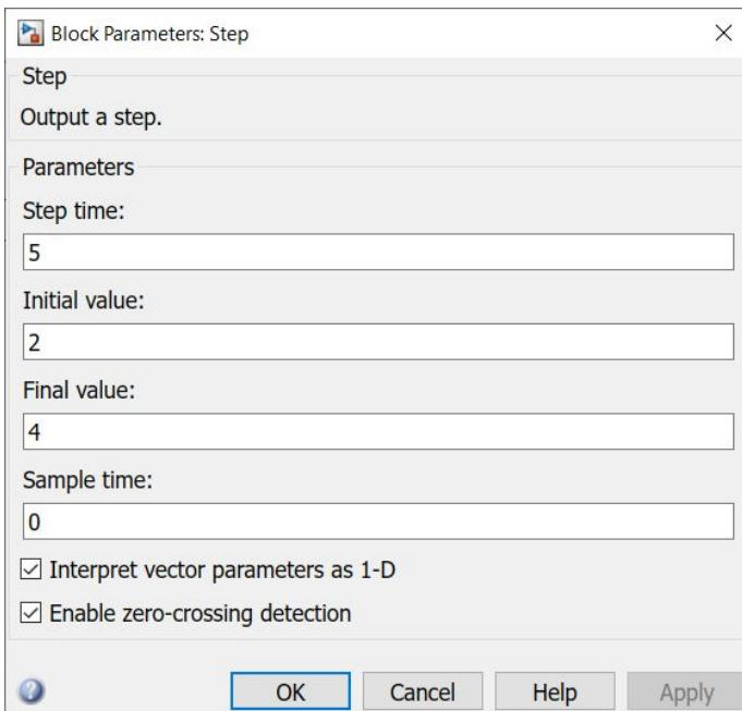
Genera una señal que toma el valor configurado en **Initial Value** hasta que  $t$  sea igual a **Step time**. Luego la señal toma el valor configurado en **Final Value**.
