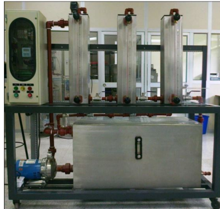
Figura 6.1: Foto de la planta de control de nivel
